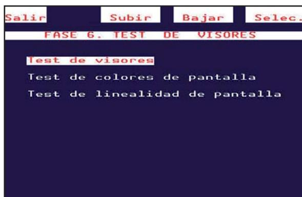
El menú **TEST DE VISORES** permite acceder a tres fases cuya finalidad es comprobar los visores display de siete segmentos y facilitar el mantenimiento de los circuitos de video.
