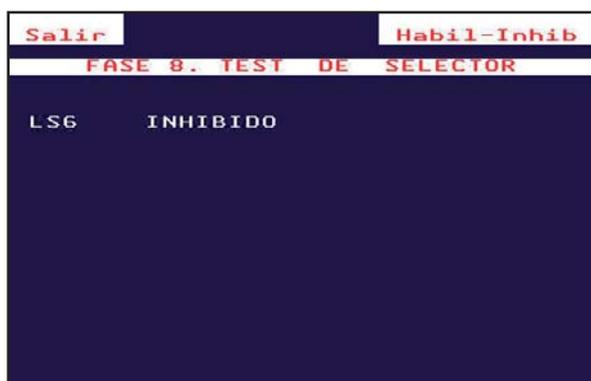
El menú **TEST DE SELECTOR** permite verificar el funcionamiento del selector y desvíos para las diferentes monedas que acepta la máquina. Para realizar esta fase abrir la puerta.
