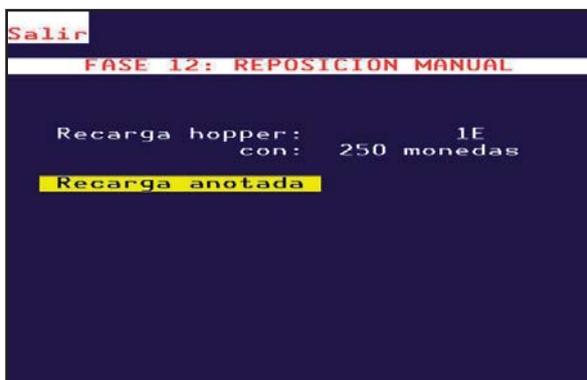
El mensaje “**Recarga anotada**” aparece en la pantalla. Pulsar **1** para abandonar la fase y a continuación realizar la carga de las monedas en el descargador seleccionado.
