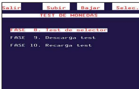
El menú **TEST DE MONEDAS** permite acceder a diferentes fases cuya finalidad es verificar el funcionamiento de los componentes del circuito de monedas: selector, desviador, descargadores y canales.
