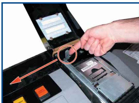
Figura 6.17 Palanca Fijación Lector Billetes
