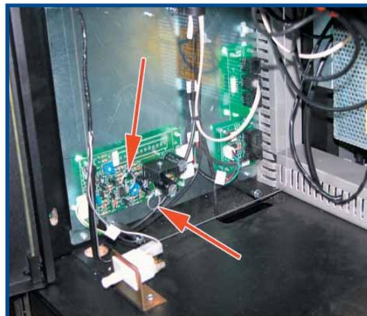
Figura 5.2 Módulo Amplificador
