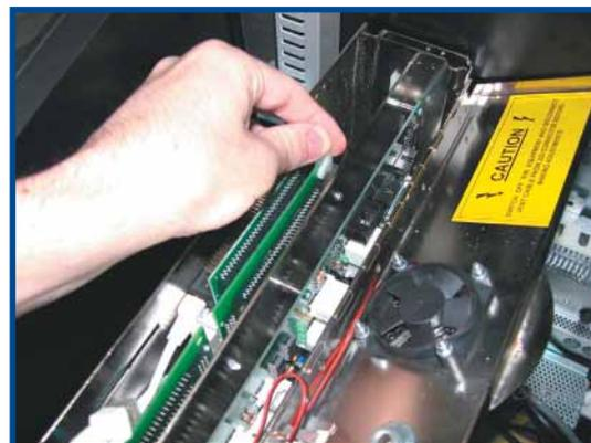
Figura 6.9 Palanca de Extracción
