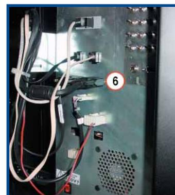
Figura 4.8 Conexión VGA a Rack Host
