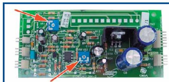
Figura 5.3 Potenciómetros Volumen
