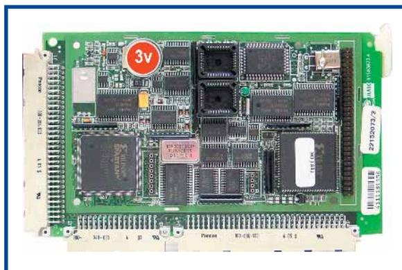
**Figura 6.13 Localización de la Batería de Litio**
