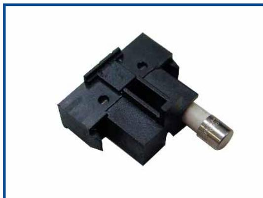
*Figura 6.6 Cambiar Fusible*
