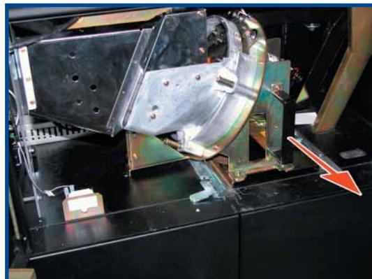
**Figura 5.6** Desplace el Hopper hacia el exterior
