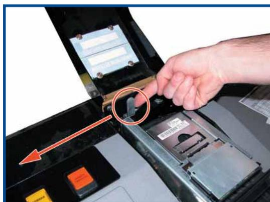
Figura 5.14 Palanca Fijación Lector Billetes
