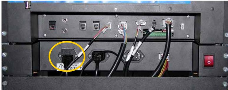
Conectar el cable de alimentación en el conector hembra de tensión.
