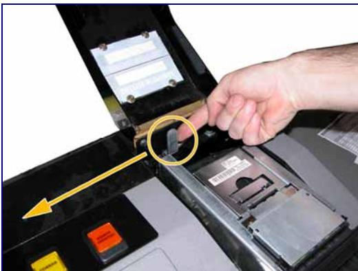
2. Presione la palanca hacia la izquierda (ver ilustración de la izquierda).
