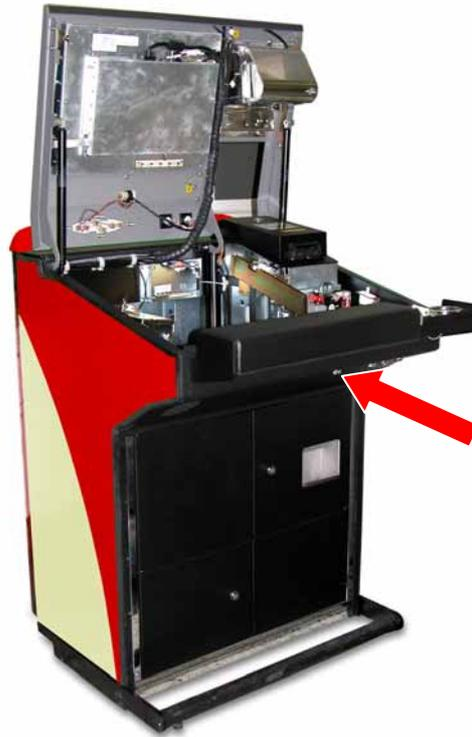
Colocar el satélite en el lugar de instalación y mediante la llave abrir la bandeja superior.
