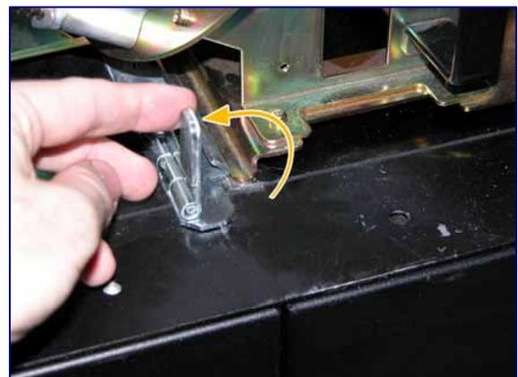
5. Sujete el asa del hopper con la mano y desplácelo hacia fuera (Ilustración 1). Para una correcta extracción, deberá mover el Escalator (ilustración 2) e inclinar el hopper para facilitar su extracción.
