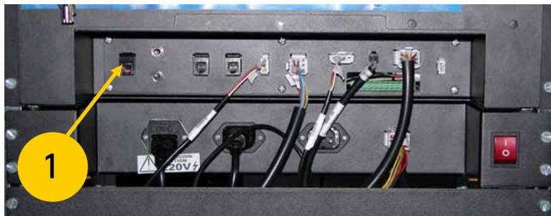
Conectar la comunicación Ethernet (ilustración superior: **Número 1**) al conector **RJ45** indicado en la ilustración superior:
