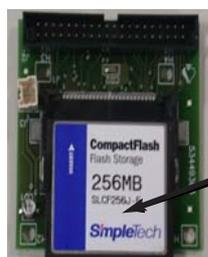
Tarjeta Compact Flash en placa interconexión Sistema Operativo
