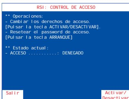
Permite habilitar o inhibir la comunicación entre la máquina y un PC.
