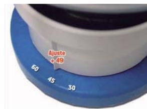
**Nota :** En el soporte tambor se indican marcas cada 5 grados. La posición inicial es -1 y +1 (no existe la posición 0) y cada paso supone un desplazamiento de 2 grados.
