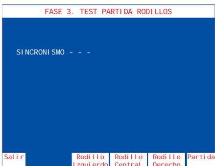
Accionando el pulsador **8**, se efectúa una partida de alineamiento. Con los pulsadores **2**, **3** y **4**, correspondientes a cada rodillo, se realizan avances de figura a figura, indicando en la pantalla su posición en la banda del rodillo.
