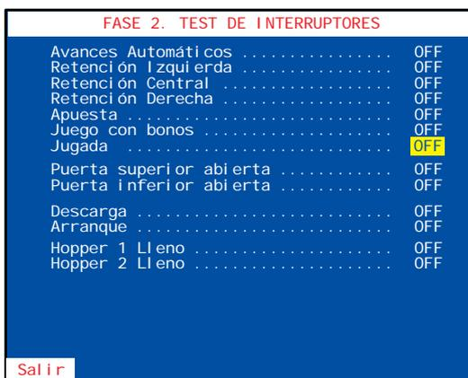
La pantalla muestra el estado de los interruptores. Al accionar cualquiera de ellos, su estado conmuta de **OFF** a **ON**, recuperando después su estado inicial si se trata de un pulsador. Los interruptores ya verificados quedan resaltados con un fondo amarillo.
