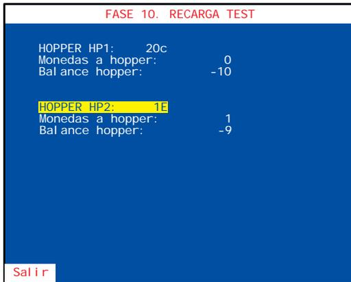
Permite recargar las monedas extraídas en la **fase 9 Descarga test** y devolverlas a través del selector, hasta conseguir el **balance hopper a CERO**, para no alterar la contabilidad. Para realizar esta fase cerrar la puerta.
