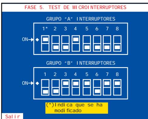
Para no entrar en el **Fuera de Servicio SAT 15**, al abandonar la fase de Test, volver el microinterruptor a su posición original.
