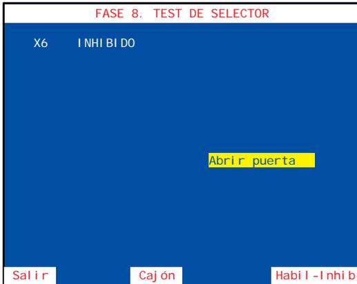
El menú **TEST DE SELECTOR** permite verificar el funcionamiento del selector y desvíos para las diferentes monedas que acepta la máquina. Para realizar esta fase abrir la puerta.
