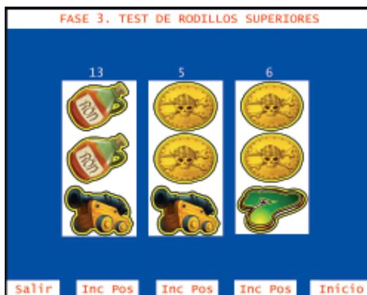
Con los pulsadores **2**, **3** y **4**, correspondientes a cada rodillo, se realizan avances paso a paso de cada figura indicando, en la pantalla, su posición en la banda del rodillo.
