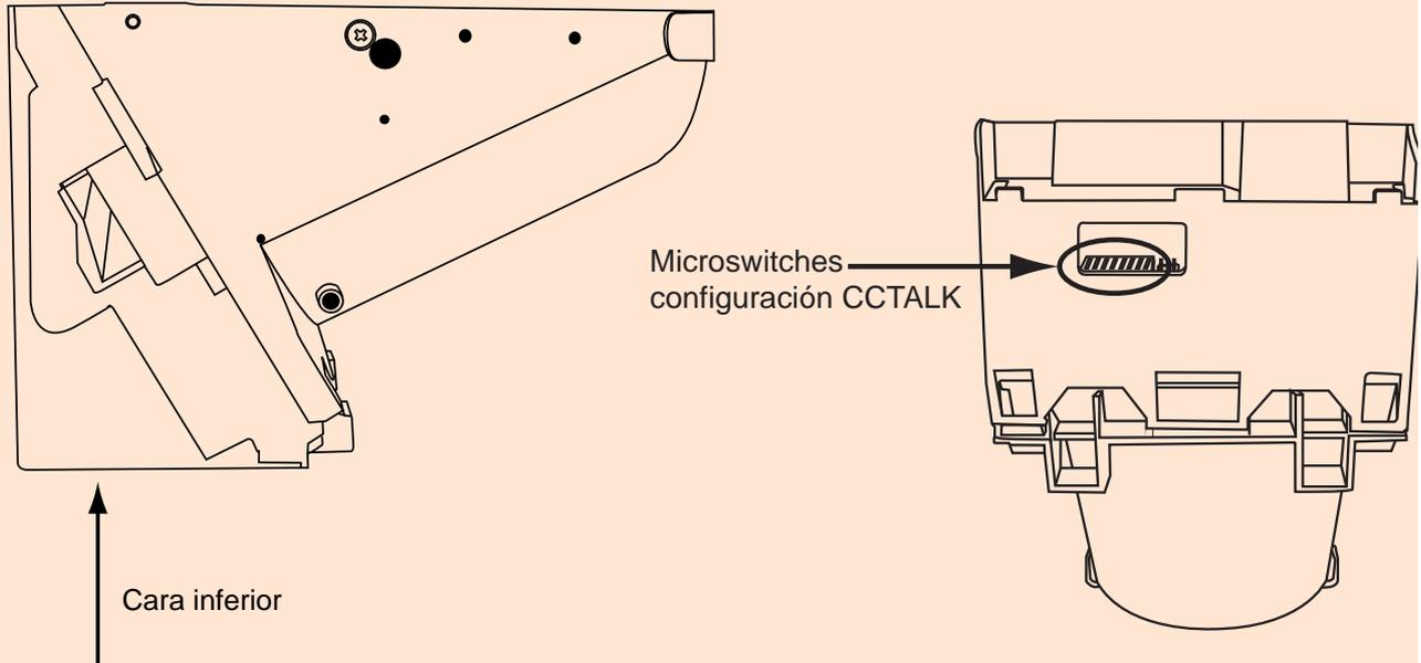
Dicha configuración se debe revisar siempre que se cambie o desmonte uno o los dos hoppers, ya sea por operaciones de recaudación, puesta en servicio o cualquier otro motivo. Es muy importante que el hopper en la **POSICIÓN “HP1”** esté configurado como “HP1“, esta consideración debe aplicarse de igual manera al “HP2”. **En caso de configurar dos o más hoppers con la misma dirección la máquina quedará FUERA DE SERVICIO.**
