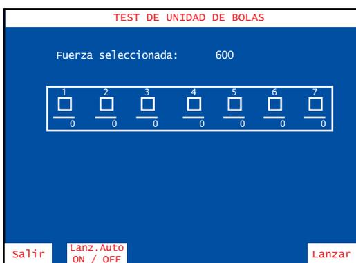
En esta fase el técnico deberá comprobar que el funcionamiento de la unidad de bolas es correcto, ya sea lanzando la bola manualmente ( botón “Lanzar” ) o pulsando el botón de lanzamiento automático y que la máquina realice la operación.
