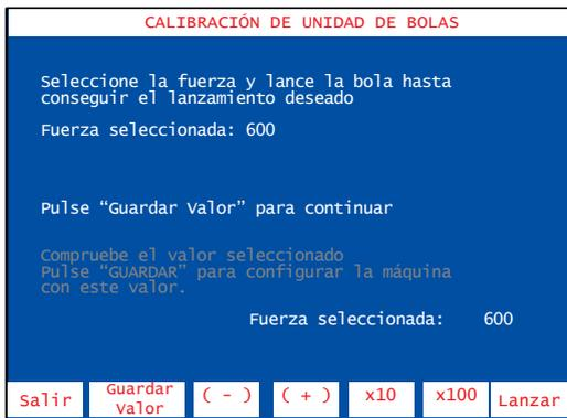
Para calibrarla se debe acceder a la subfase **Calibración de Unidad de bolas**. En esa subfase el técnico debe seguir los pasos que le indica la máquina para calibrarla.
