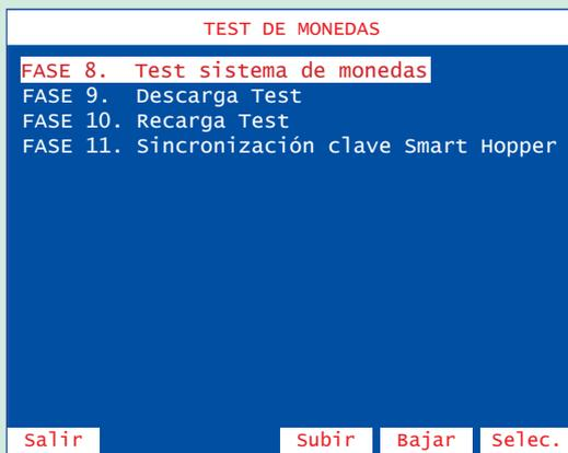
El menú **TEST DE MONEDAS** del sistema GIM permite acceder a diferentes fases cuya finalidad es verificar el funcionamiento de los componentes del circuito de monedas.
