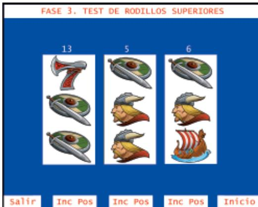
Con los pulsadores **3**, **4** y **5**, correspondientes a cada rodillo, se realizan avances paso a paso de cada figura indicando, en la pantalla, su posición en la banda del rodillo.
