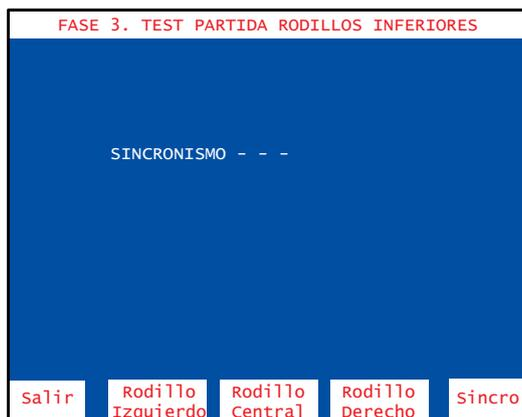
Accionando el pulsador **8**, se efectúa una partida de alineamiento. Con los pulsadores **3**, **4** y **5**, correspondientes a cada rodillo, se realizan avances de figura a figura, indicando en la pantalla su posición en la banda del rodillo.
