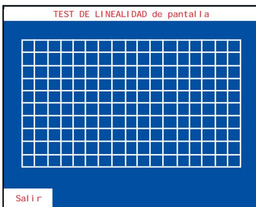
Comprobación de la linealidad del monitor para facilitar el ajuste de los circuitos de geometría.
