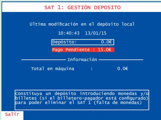
En esta situación, si se pulsaran simultáneamente los pulsadores **1** y **8** durante 5 segundos, se accederá a una fase en la que se pueden introducir monedas y billetes en la máquina para recuperar el pago pendiente. Una vez introducida la cantidad suficiente, el error se recuperará y la máquina podrá realizar el pago pendiente.
