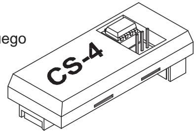
La memoria utilizada en este módulo es del tipo E2prom, lo cual permite el mantenimiento de los datos con la máquina desconectada, por un tiempo indefinido, sin precisar para ello ninguna batería de alimentación.
