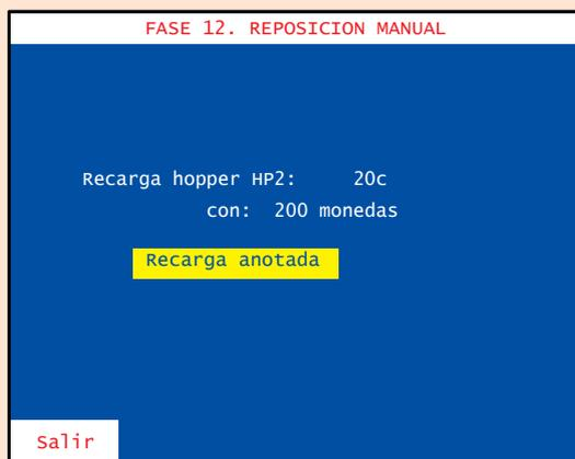
El mensaje “**Recarga anotada**” aparece en la pantalla. Pulsar **1** para abandonar la fase y a continuación realizar la carga de las monedas en el descargador seleccionado.
