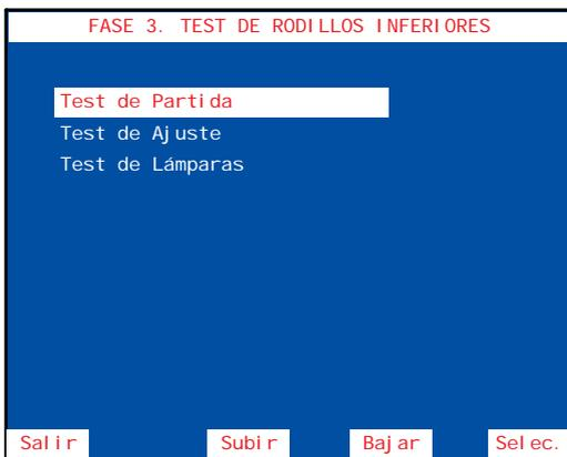
Verificación del funcionamiento de los rodillos inferiores. Seleccionar la fase mediante los pulsadores **4** y **5**, a continuación pulsar **8** para acceder a la fase.
