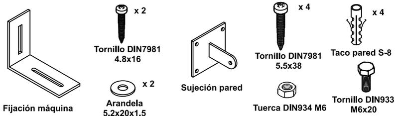
Procedimiento para la fijación mecánica a la pared :
