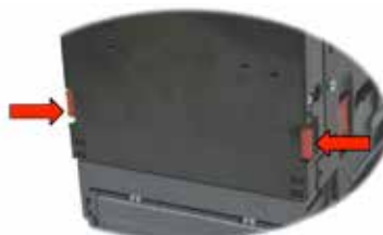
Figura 5: Apertura de la compuerta del Note Float
