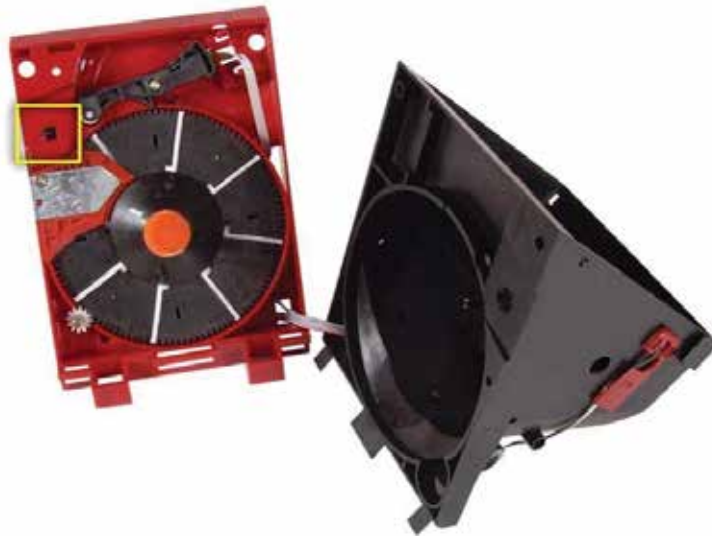
Figura 27. Limpieza Hopper U-II
