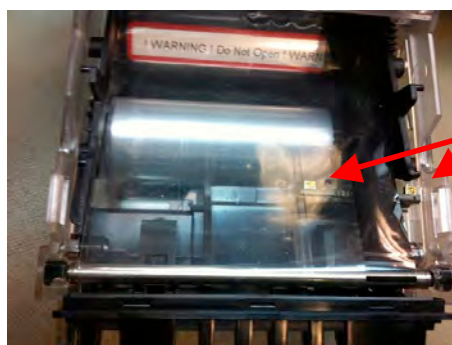
Figura 6: emplazamiento de Light pipe y sensores en el Note Float
