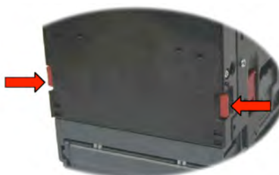
Figura 5: Apertura de la compuerta del Note Float
