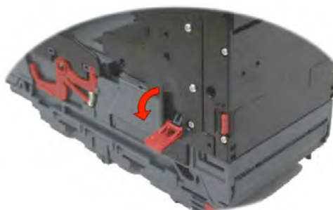
Figura 4: Sujeciones que unen el Note Float del NV9US
