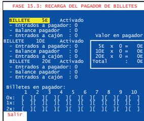
Permite recargar los billetes extraídos en la fase 'Test del pagador de billetes', hasta conseguir un 'balance pagador' a cero. Los billetes insertados se dirigen al pagador.
