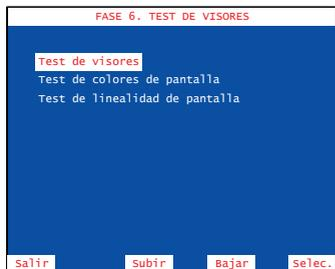
El menú **TEST DE VISORES** permite acceder a tres fases cuya finalidad es comprobar los visores y facilitar el mantenimiento de los circuitos de video y monitor TFT.
