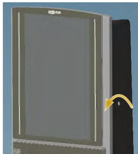
Figura 4.1.5.a Apertura puerta principal
