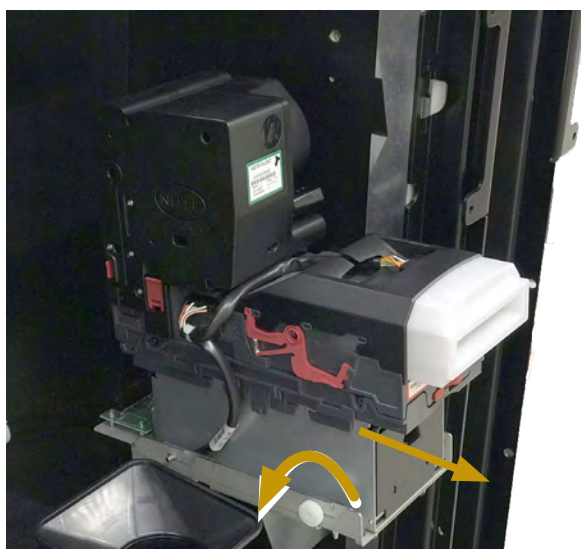
Figura 4.1.1 Extracción Módulo NV11
