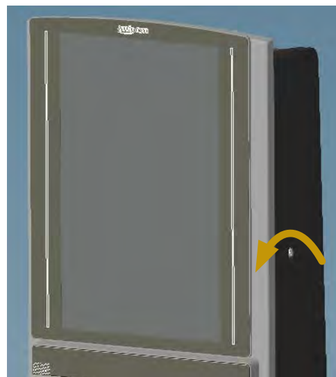
Figura 1.7.a Apertura puerta principal
