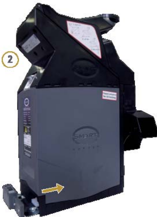
Figura 4.2.e Extracción Smart Hopper 2
