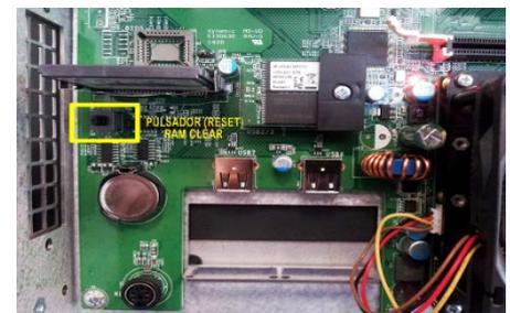
Con la máquina apagada presionamos el pulsador RAM CLEAR. Conectamos la máquina y nos aparecerá en pantalla la confirmación del inicio del proceso con una cuenta atrás de 20 segundos. Si no realizamos ninguna acción, la máquina procederá a la carga normal del software del juego.
