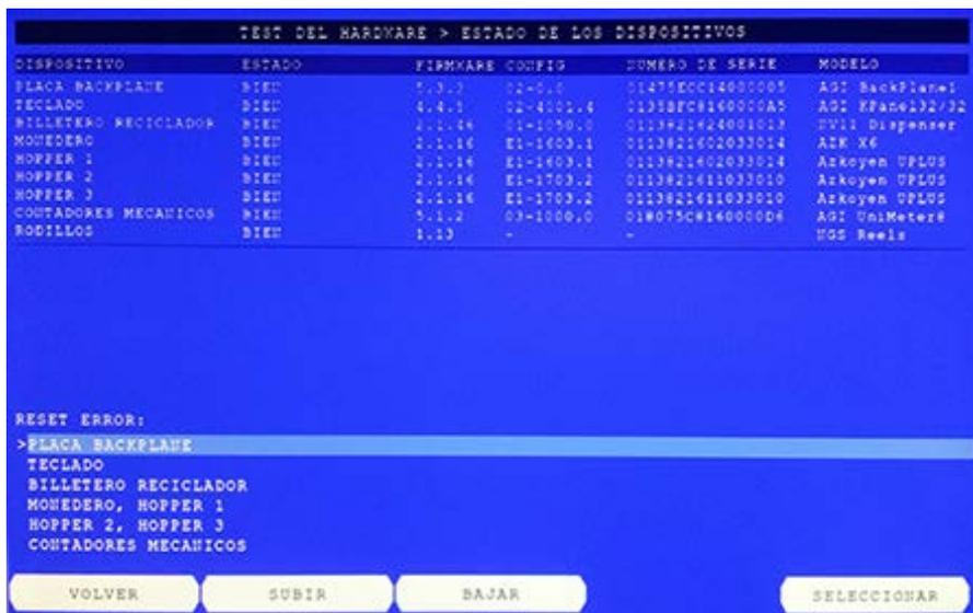
**NOTA:** No se puede realizar un reset a un dispositivo en estado DESCONECTADO.
