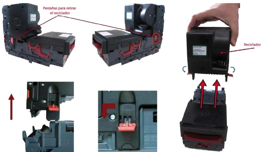
Apretando las dos pestañas laterales del reciclador lo abrimos, colocamos la llave que incorpora el lector, y la giramos en el sentido que indica la flecha para ir extrayendo los billetes.
