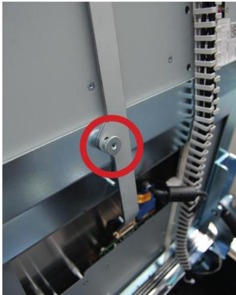
Fig. 37 Tornillo de cabeza en el monitor
