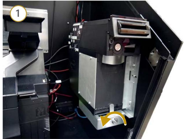
**Figura 4.4.b** Abrir Cerradura Seguridad
