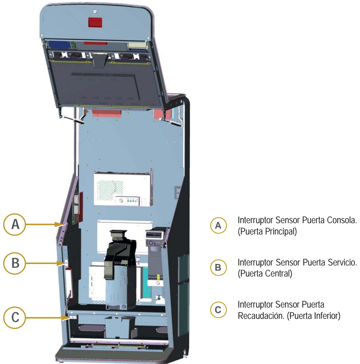
**Figura 3.6.a Elementos sensores de puertas**
