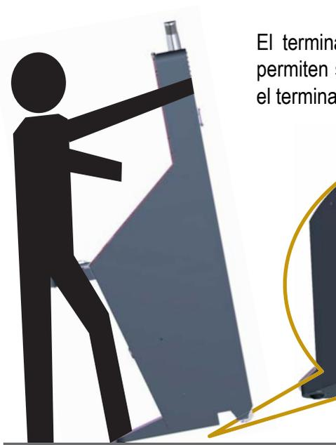
El terminal en la parte inferior posterior dispone de dos pies niveladores que permiten su retención, anulando el efecto de las ruedas de transporte al empujar el terminal.
