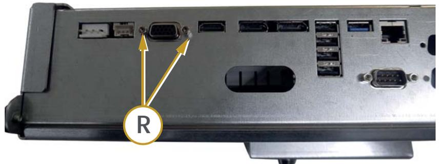
**Figura 4.7.q Fijar Torretas conector VGA**
