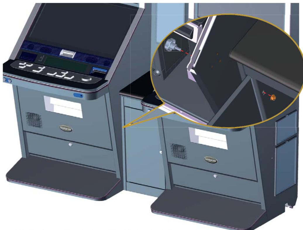
**Figura 1.6.l Unión Grupo Terminales - Fijación izquierda Separador Peana**
