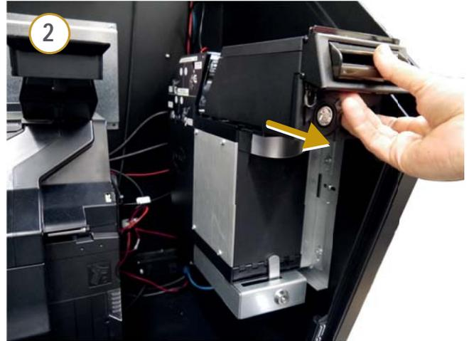
**Figura 4.4.f Extracción Cabezal - 2**
