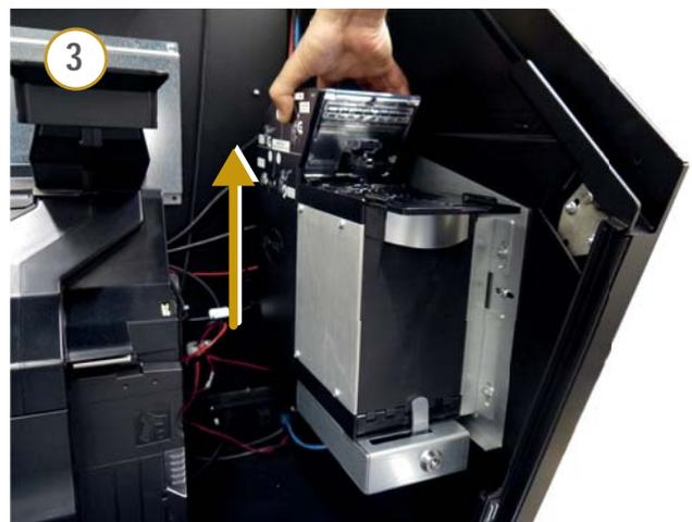
**Figura 4.4.h Extracción Cabezal - 2**
