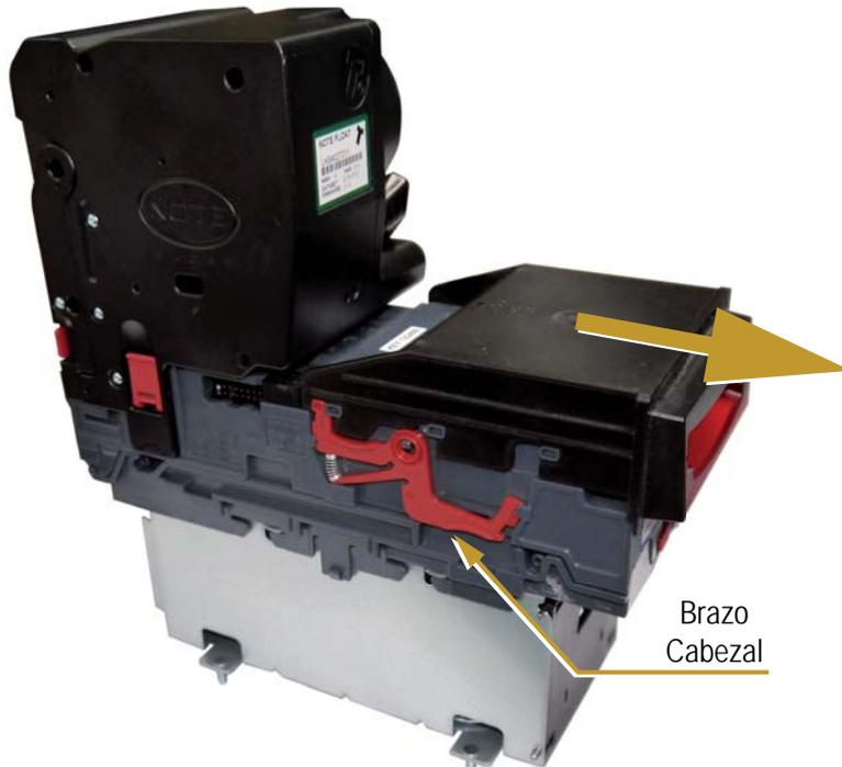
**Figura 4.1.h Extracción cabezal**
