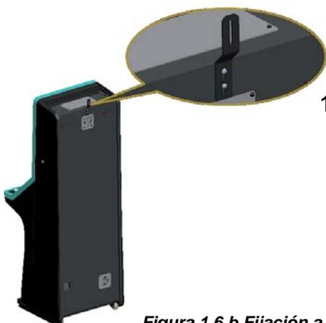
Figura 1.6.b Fijación a la Pared
