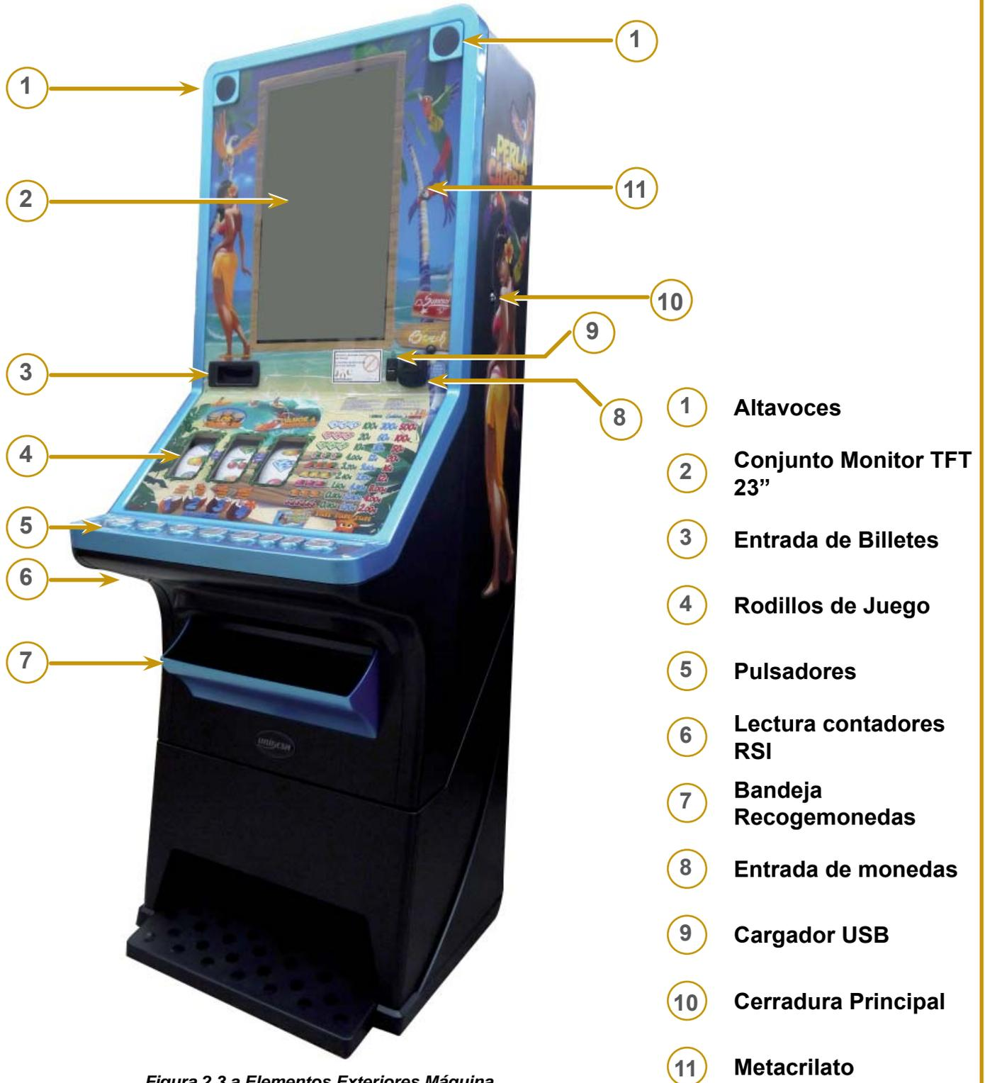
Figura 2.3.a Elementos Exteriores Máquina
