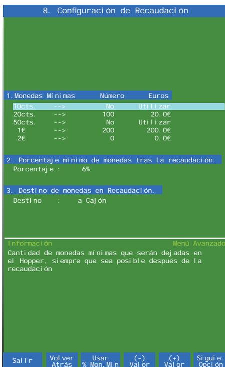
**Figura 7.6b Configuración de Recaudación**
