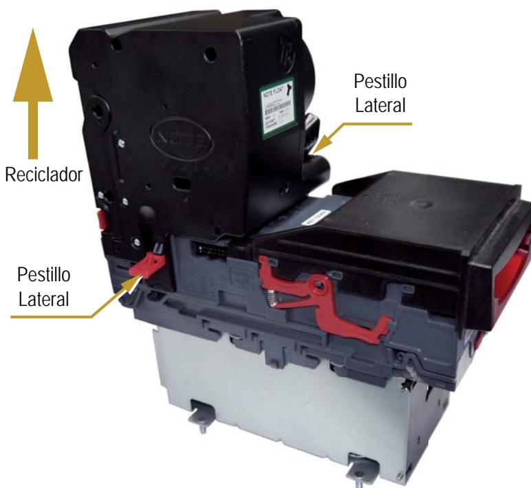
**Figura 4.1.e Desmontaje Reciclador**
