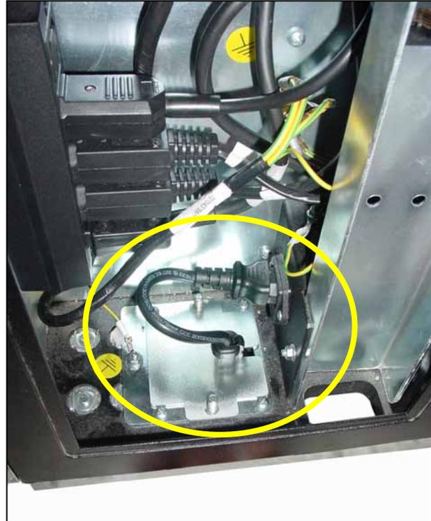
**Figura 4.3.g** Conexión del cable de red.
