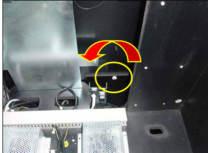
Figura 4.3.a Tuerca fijación tapa posterior.
