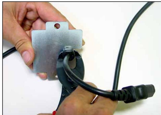
**Figura 4.3.f** Fijación del pasacables antitracción a la tapa de salida del cable de red.
