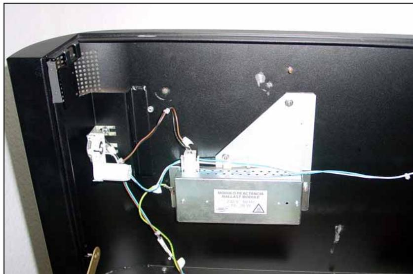
Figura 6.3.b Módulo reactancia en suplemento superior.
