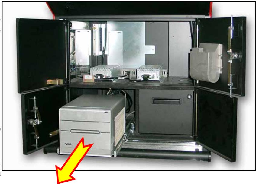
Figura 6.4.a Extracción del PC Barebone.
