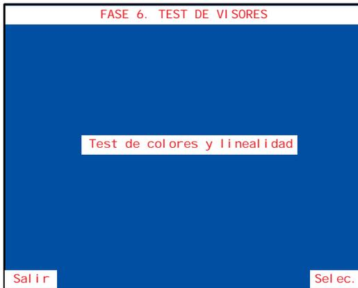
El menú **TEST DE VISORES** permite acceder a una fase cuya finalidad es comprobar la paleta de colores RGB y la linealidad del monitor para facilitar el ajuste de los circuitos de geometría.
