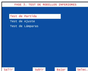
Verificación del funcionamiento de los rodillos inferiores. Seleccionar la fase mediante los pulsadores **4** y **5**, a continuación pulsar **8** para editar la fase.
