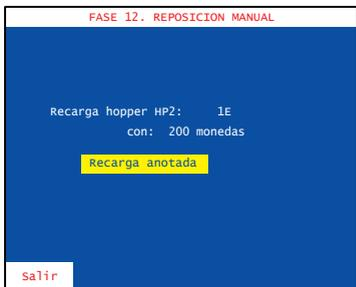
El mensaje “**Recarga anotada**” aparece en la pantalla. Pulsar **1** para abandonar la fase y a continuación realizar la carga de las monedas en el descargador seleccionado.
