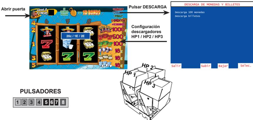
Las monedas descargadas se contabilizan en los contadores C0045 / C1045 (HP1), C0065 / C1065 (HP2) y C0055 / C1055 (HP3).
