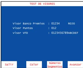
Comprobación de los visores display de siete segmentos (visor 1 y visor 2) y VFD.
