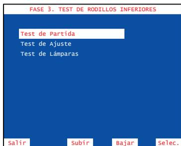
Verificación del funcionamiento de los rodillos inferiores. Seleccionar la fase mediante los pulsadores **3** y **4**, a continuación pulsar **8** para acceder a la fase.
