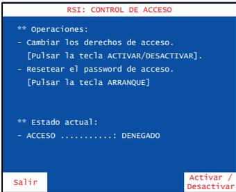
Permite habilitar o inhibir la comunicación entre la máquina y un PC.
