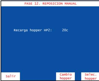
Permite cargar monedas en el descargador (carga inicial, reposición de monedas por vaciado, averías o diferencia de arqueo y descarga final). Las monedas introducidas forman parte de la contabilidad de monedas disponibles en el descargador.
