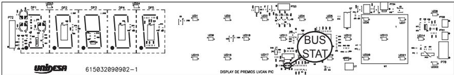
Los Leds marcados en los diagramas como **BUS STAT** se denominan Leds de estado, indican el estado de funcionamiento del BUS CAN, si todo funciona correctamente el Led rojo siempre está apagado.
