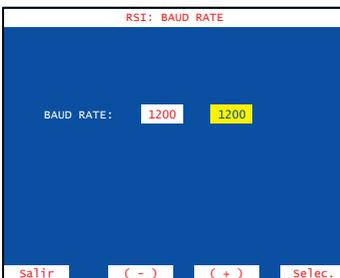
Permite elegir la velocidad de comunicación (entre 600 y 19.200 bauds). La velocidad por defecto es 1.200 bauds.
