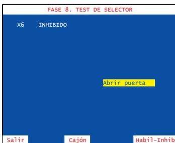
El menú **TEST DE SELECTOR** permite verificar el funcionamiento del selector y desvíos para las diferentes monedas que acepta la máquina. Para realizar esta fase abrir la puerta.
