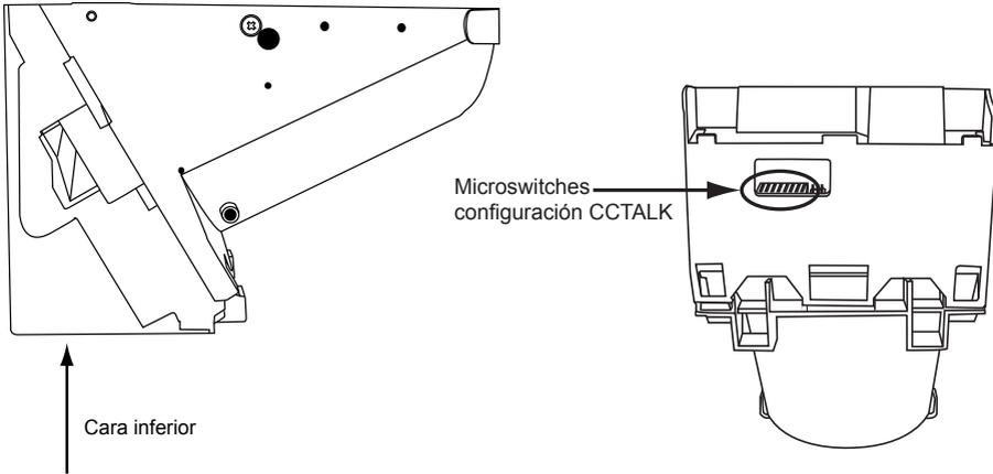
Dicha configuración se debe revisar siempre que se cambie o desmonte uno o los dos hoppers, ya sea por operaciones de recaudación, mantenimiento o cualquier otro motivo. Es muy importante que el hopper en la **POSICIÓN "HP1"** esté configurado como **"HP1"**, esta consideración debe aplicarse de igual manera al **"HP2"**. **En caso de configurar dos o más hoppers con la misma dirección la máquina quedará FUERA DE SERVICIO.**
