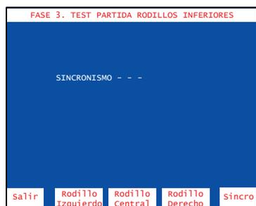
Accionando el pulsador **8**, se efectúa una partida de alineamiento. Con los pulsadores **2**, **3** y **4**, correspondientes a cada rodillo, se realizan avances de figura a figura, indicando en la pantalla su posición en la banda del rodillo.
