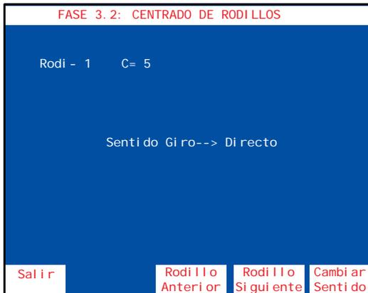
Es la fase de ajuste de los rodillos. En ella se comprueba que el valor de centrado de los rodillos esté entre 2 y 5. Para ajustarlo correctamente se actúa sobre la Guía Sensor que posee el rodillo. Con el pulsador **2** se selecciona el rodillo anterior y con el pulsador **3**, el siguiente. Con el pulsador **4** se cambia el sentido de giro del rodillo.
