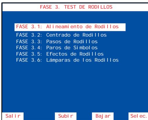
El menú **TEST DE RODILLOS** permite acceder a seis subfases cuya finalidad es verificar el funcionamiento de los rodillos.
