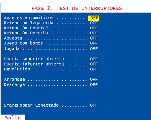
La pantalla muestra el estado de los interruptores. Al accionar cualquiera de ellos, su estado conmuta de **OFF** a **ON**, recuperando después su estado inicial si se trata de un pulsador. Los interruptores ya verificados quedan resaltados con un fondo amarillo.
