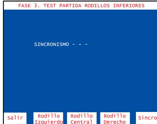
Accionando el pulsador **8**, se efectúa una partida de alineamiento. Con los pulsadores **3**, **4** y **5**, correspondientes a cada rodillo, se realizan avances de figura a figura, indicando en la pantalla su posición en la banda del rodillo.
