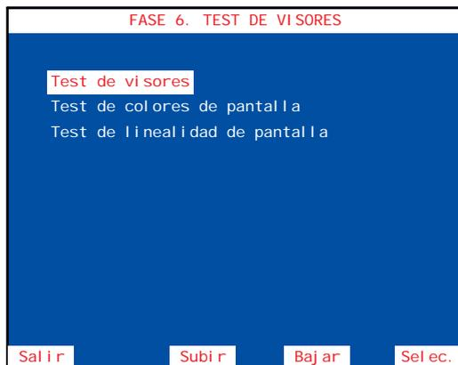
El menú **TEST DE VISORES** permite acceder a tres fases cuya finalidad es comprobar los visores y facilitar el mantenimiento de los circuitos de video y monitor TFT.
