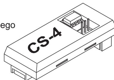
La memoria utilizada en este módulo es del tipo E2prom, lo cual permite el mantenimiento de los datos con la máquina desconectada, por un tiempo indefinido, sin precisar para ello ninguna batería de alimentación.
