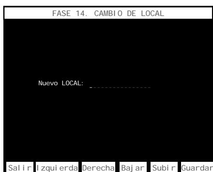
Mediante los pulsadores **2** y **3** se elige el registro, a continuación mediante los pulsadores **4** y **5** se avanza o retrocede en la secuencia. Una vez modificados los datos, pulsar **8** para validar los cambios.
