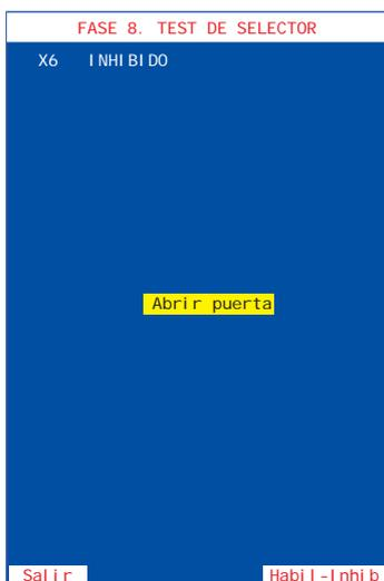
El menú **TEST DE SELECTOR** permite verificar el funcionamiento del selector y desvíos para las diferentes monedas que acepta la máquina. Para realizar esta fase abrir la puerta.
