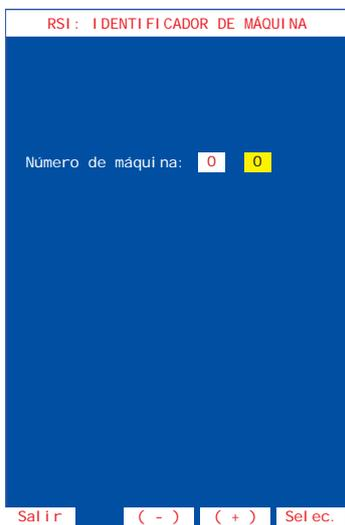
Permite numerar la máquina para su identificación en un Link. Seleccionar el número de máquina mediante los pulsadores **3** o **4**, a continuación pulsar **8** para validar la operación.
