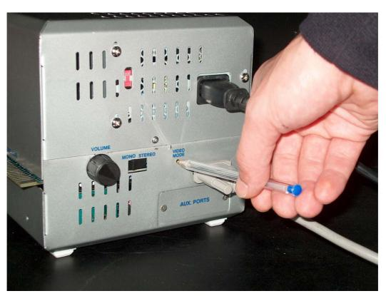
· Con un bolígrafo o punta similar, pulse el botón MODO VIDEO hasta oír un mensaje indicando el modo video seleccionando. Ex: PAL VIDEO MODE · Una vez seleccionado el MODE DE VIDEO, proceda a pulsar el botón de TEST (ver posición en Jamma) para memorizar. Seguidamente deberá apagar y conectar nuevamente la maquina para que el sistema memorice el modo de video seleccionado.
