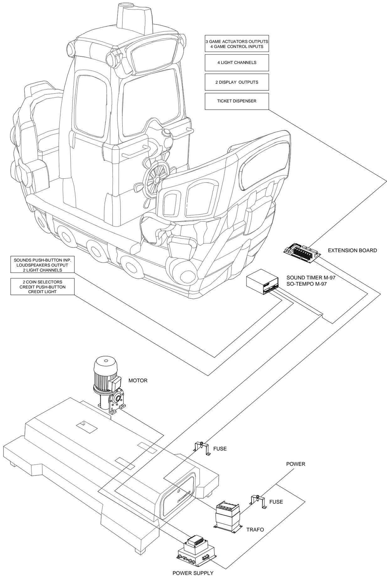
3.2- ESQUEMA DE INSTALACIÓN · WIRING DIAGRAM
