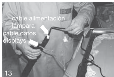
INTRODUCIR CABLES POR EL SOPORTE. INSERT WIRING THRU SUPPORT ( lamp feed wiring-display data wiring ).
