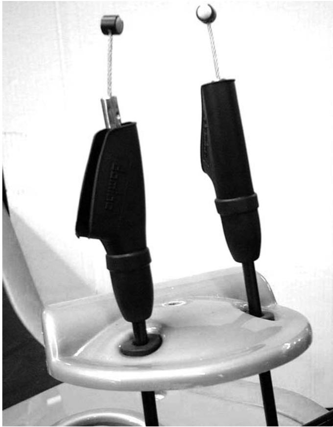
5) Se abre el cepo que sujeta a los cables
